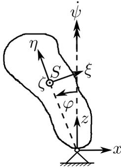
Ein Starrkörper rotiert in der Schwerelosigkeit ( $g = 0$ ) mit konstanter Winkelgeschwindigkeit  $\dot{\psi}$  mitsamt seiner drehbaren Lagerung (Drehwinkel  $\varphi$ ) um die raumfeste  $z$ -Achse. Sein Winkelgeschwindigkeitsvektor im körperfesten  $\xi\eta\zeta$ -Hauptachsensystem ist
