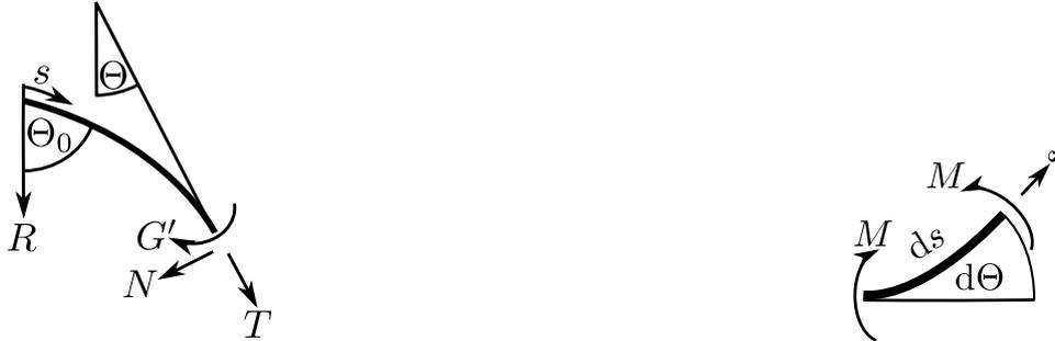
Bei großen Biegungen ist die Näherung der Krümmung  $\Theta/ds \approx w''$  nicht mehr zulässig. Die Biegelinie der sog. Elastica ergibt sich aus dem Kräftegleichgewicht in Richtung der Querkraft  $N$ . Das Schnittmoment (Biegesteifigkeit  $B = EI$ ) ist  $M = Bd\Theta/ds$  und die Schnittkraft folgt durch Differenziation nach der Bogenlänge  $N = dM/ds = Bd^2\Theta/ds^2$ . Unter Einbeziehung der äußeren Last  $R$  an der Stelle  $s = 0$  folgt
